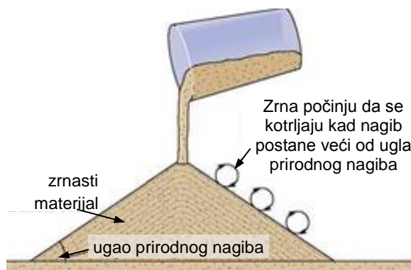
Slika 4.2 Direktno određivanje kritičnog ugla prirodnog nagiba zrnastog materijala
