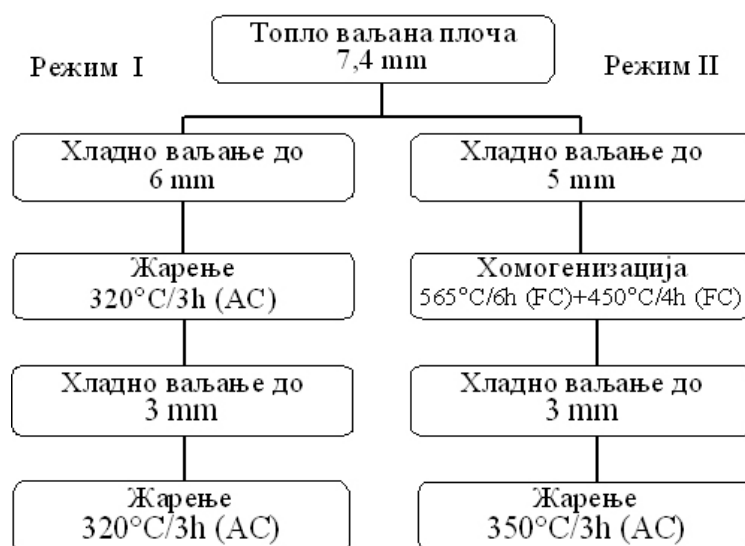
Слика 3.1. Термомеханички режим прераде AlMg3 легуре.
