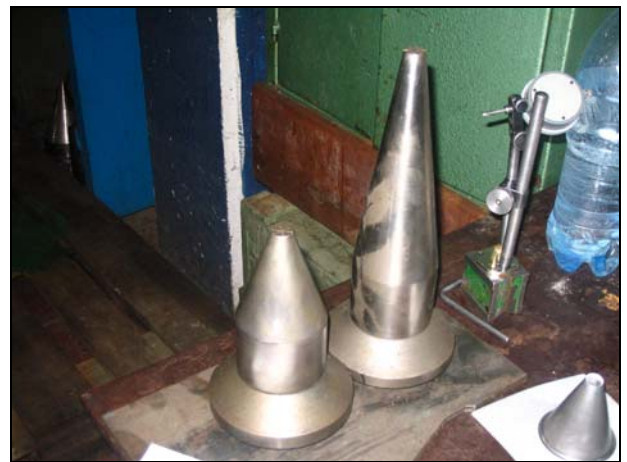
Слика 3.5. Трнови за ротационо ваљање: 2\alpha=40^\circ и 2\alpha=18^\circ .
