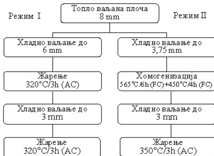
Слика 3.3. Термомеханички режим прераде AlMg6Mn легуре.
