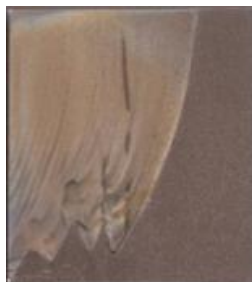
Слика 7.5. Узорак број 12, p_5 = 205 \text{ MPa} , v_c = 35 \text{ mm/min} , m_a = 400 \text{ g/min} , X5CrNi 18–10, # 30 mm
