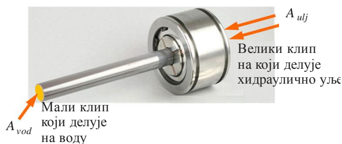
Слика 2.5. Однос површина одређује степен појачавања притиска [42]
