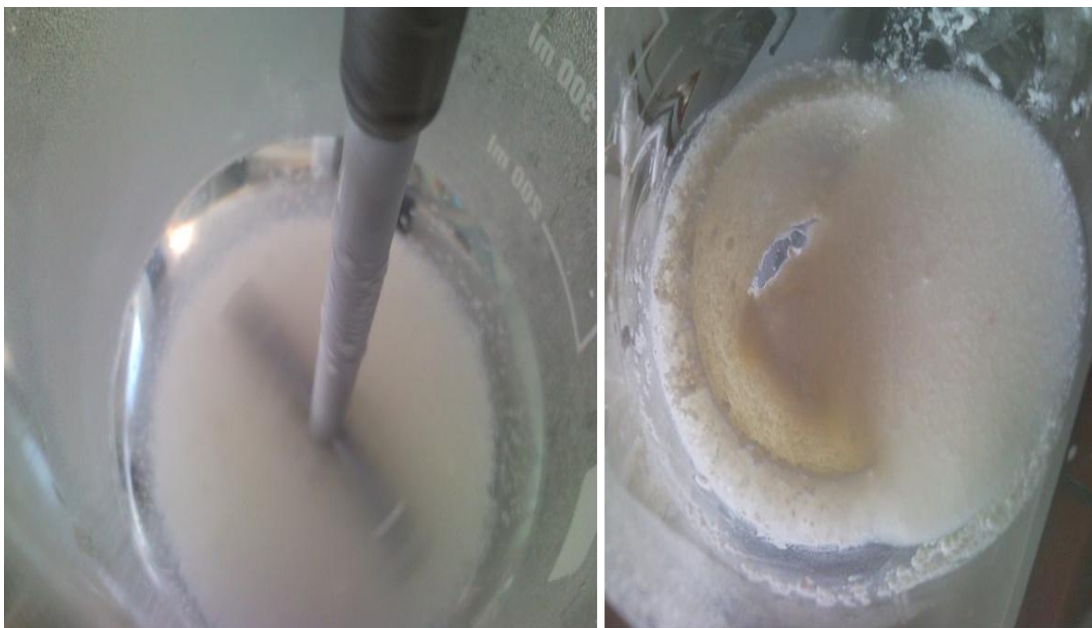
Slika 33. Ispitivanje brzine rastvaranja ciprofloksacin-hidrohlorida u vodi u prisustvu kalcijum-karbonata – izgled uzoraka
