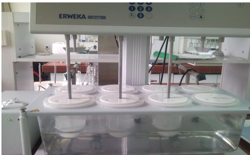
Slika 26. Ispitivanje brzine rastvaranja ciprofloksacin-hidrohlorida u vodi u prisustvu aluminijum-hidroksida – izgled uzorka
