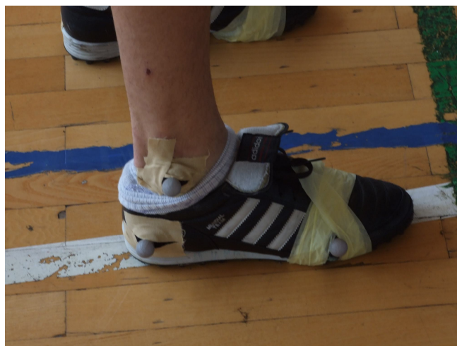
Slika 16.2. Način postavljanja markera na skočni zglob i stopalo. Markeri na peti i prstima su postavljeni na gumene nosače.
