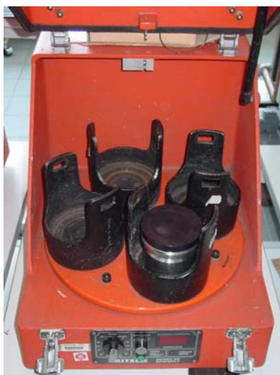
Slika 2.1. Mlin „Fritsch“ Pulverisette 5
