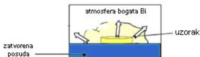
Slika 2.3. Priprema uzorka za sinterovanje
