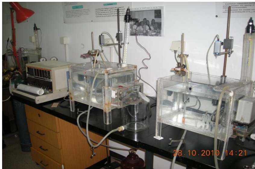
Slika 14. Eksperimentalna laboratorija za rad sa izolovanim krvnim sudovima: kupatilo za izolovane organe i sistem za registraciju signala (rukovodilac: prof. dr Ljiljana Gojković Bukarica)
