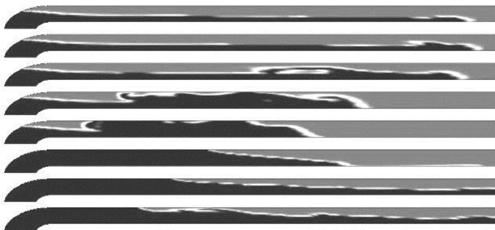
Slika 2.18 Promena zapreminskog udela parne faze i oblici strujanja dobijeni prilikom simulacije PMK 2 eksperimenta primenom CFD-a i hibridnog modela u karakterističnim vremenskim trenucima 6,8 s, 7 s, 7,2 s, 7,25 s, 7,3 s, 7,6 s, 8,4 s i 8,5 s. (Ceuca i dr., 2013)
