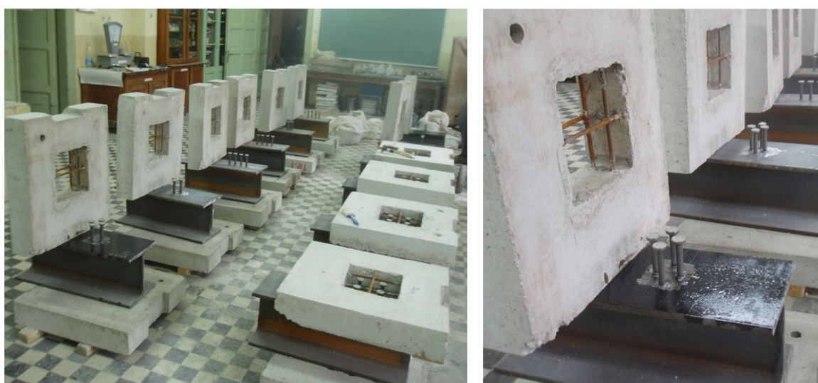
Slika 2.20: Priprema uzoraka u laboratoriji pre monolitizacije
