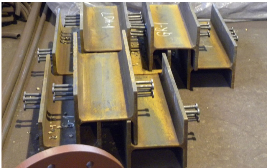
Slika 2.5: Čelični profili sa zavarenim moždanicima
