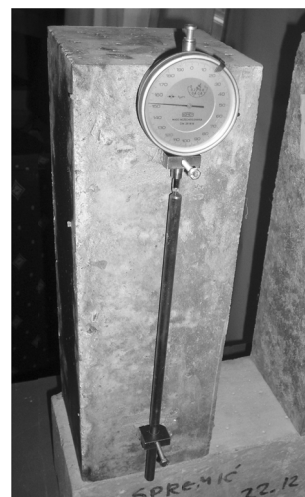
Slika 2.16: a) Dilatacija skupljanja betona kroz vreme, b) Prizma sa opremom za praćenje skupljanja
