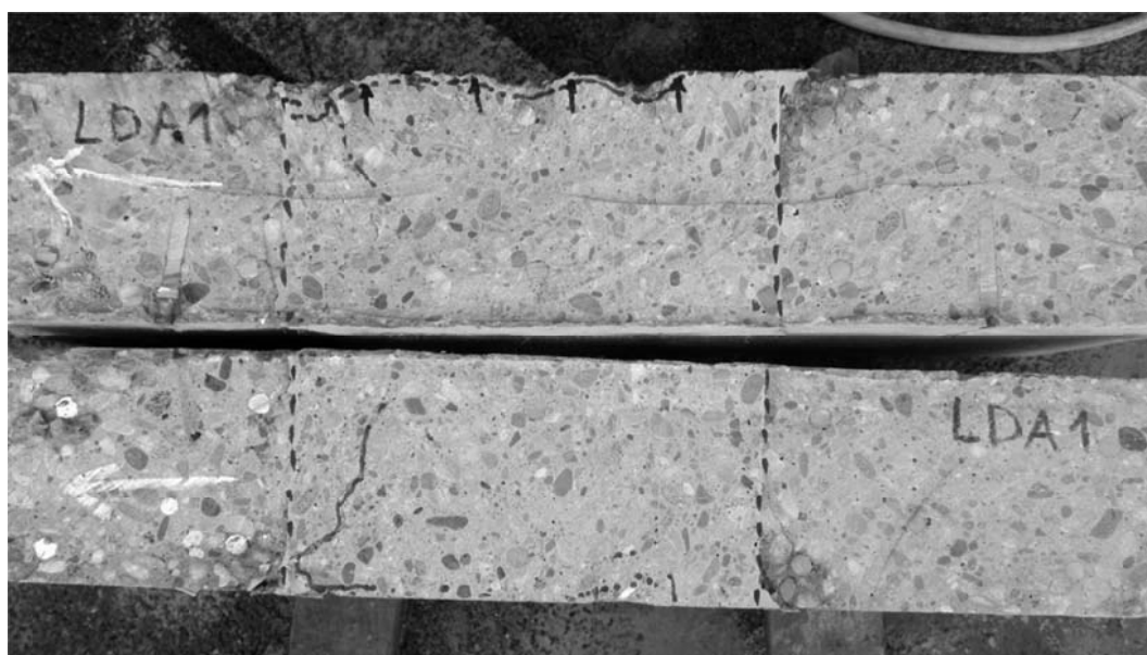
Slika 5.9: Poprečni presek armiranobetonske ploče uzorka LDA1 nakon ispitivanja
