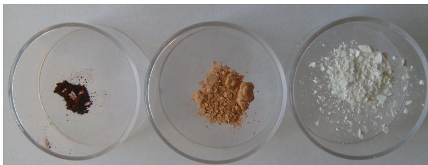
Slika 4.1.5: Izgled sintetisanih prahova (sa leva na desno): čist nikl ferit, kompozit nikl ferit–silika, čista silika
