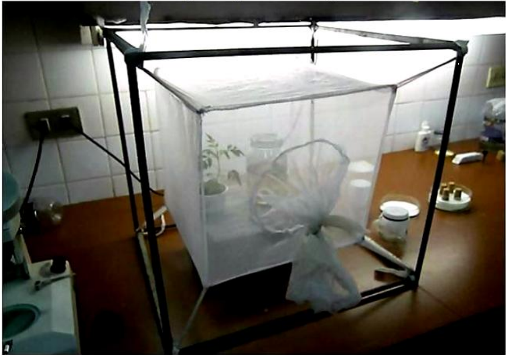
Figura 1. Jaula de 50 cm de arista donde se mantenían los imagos luego de su emergencia.
