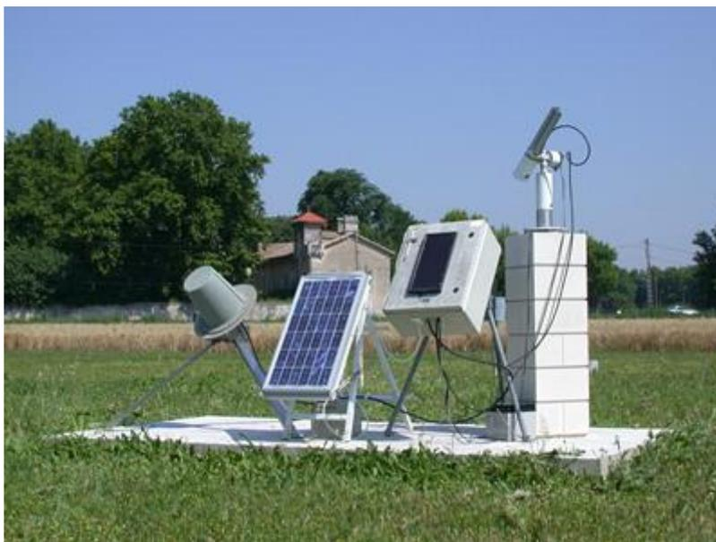
**Figura 2.3.1** Imagem de uma estação da Rede AERONET e seus componentes. Disponível em [https://aeronet.gsfc.nasa.gov/new\\_web/system\\_descriptions.html](https://aeronet.gsfc.nasa.gov/new_web/system_descriptions.html)
