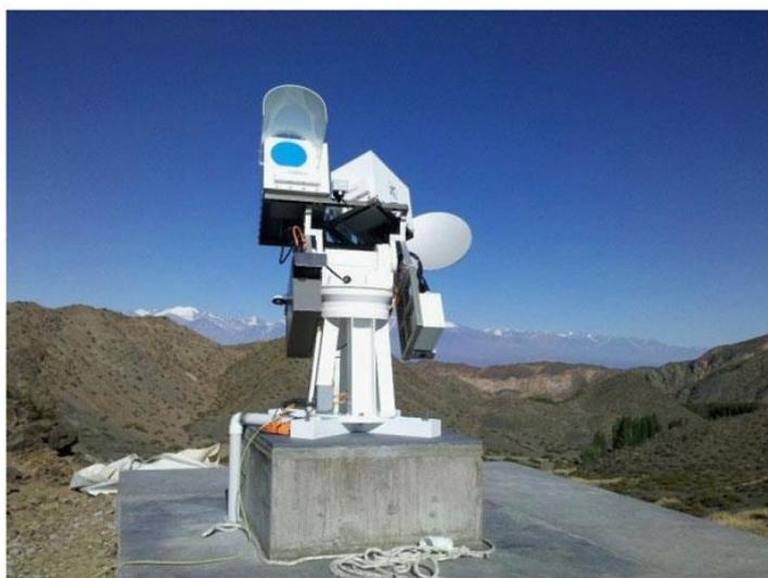
*Figura -1.1.1 - Rádios polarímetros solares POEMAS – localizados no CASLEO, Argentina (Valio, et.al.,2013)*
