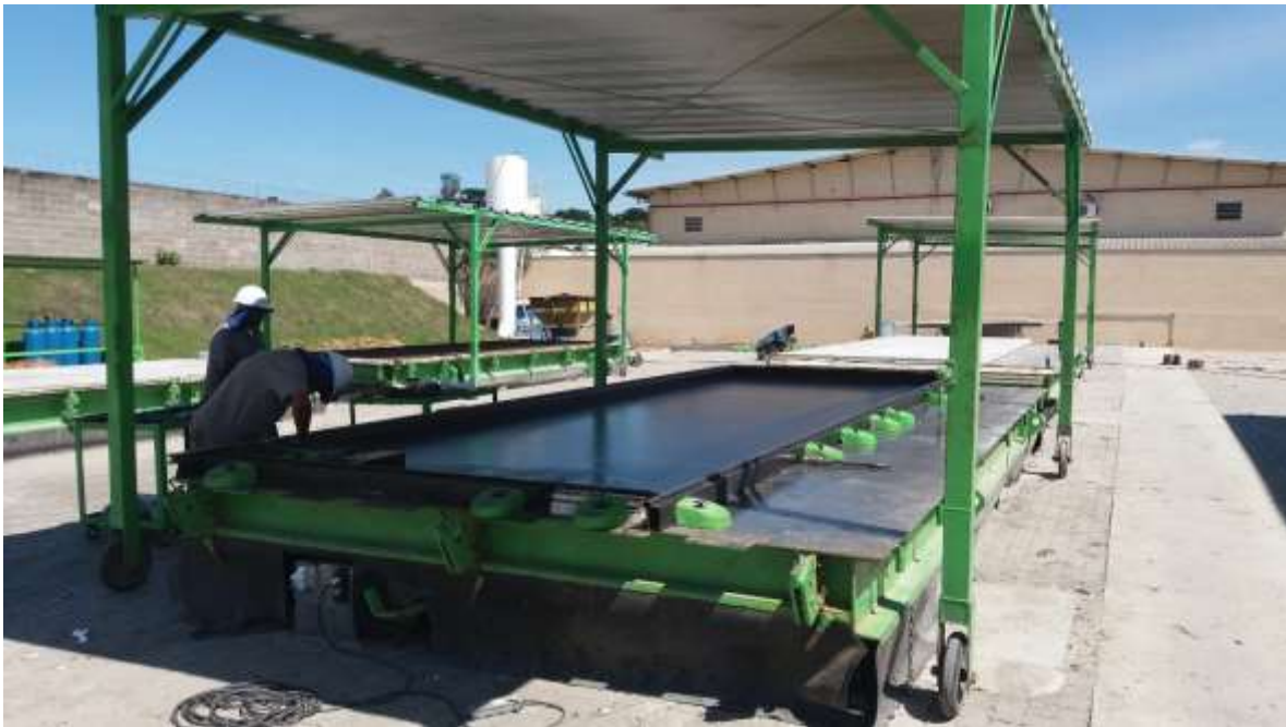
Fig. 3.4 – Fôrmas da Kronan Fonte: Acervo próprio (2017)
