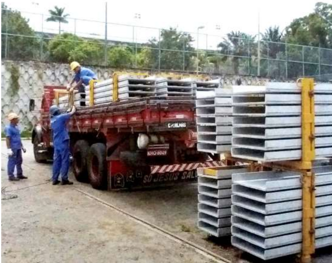
Fig. 1.69- Produção dos componentes de argamassa armada dos hospitais da rede SARAH Fonte: CAMPOS et al. (2013, p. 414-415)
