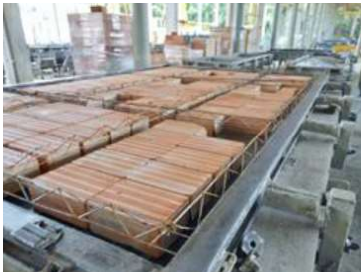
Fig. 3.8 – Blocos Cerâmicos no Interior dos Painéis da Empresa B Fonte: IFB (2017, p. 6)
