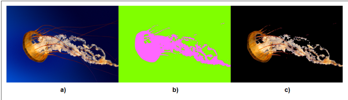
Figura 4: Exemplo de segmentação do plano de fundo em uma imagem. a) Imagem de entrada; b) Máscara de segmentação; c) Imagem com o plano de fundo removido.
