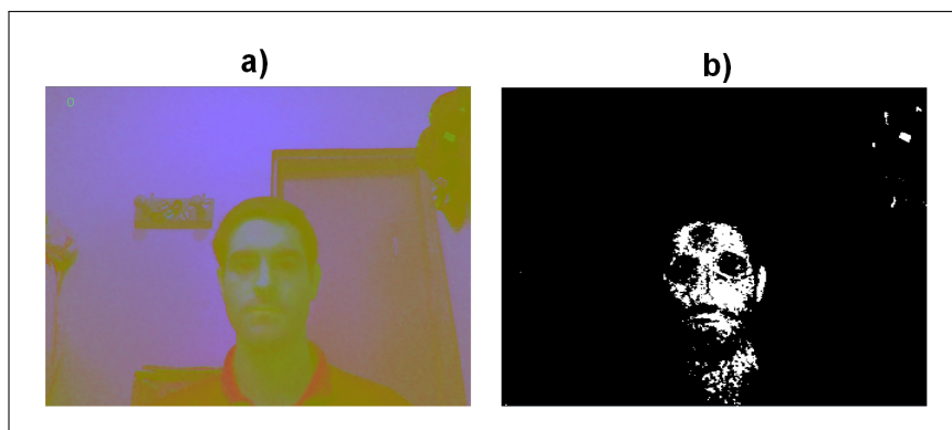
Figura 11: Segmentação de cor de pele. a) Imagem com a iluminação ajustada; b) Máscara de segmentação da pele do usuário.
