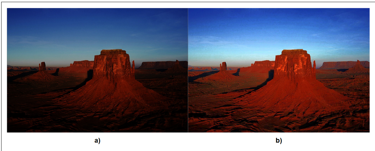
Figura 3: Exemplo de processamento de imagem. a) Imagem de entrada; b) Correção de iluminação na imagem de entrada.
