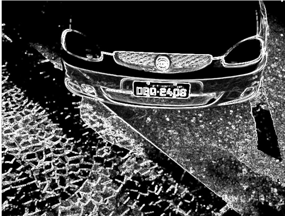
Figura 31 - Resultado da aplicação de Sobel
