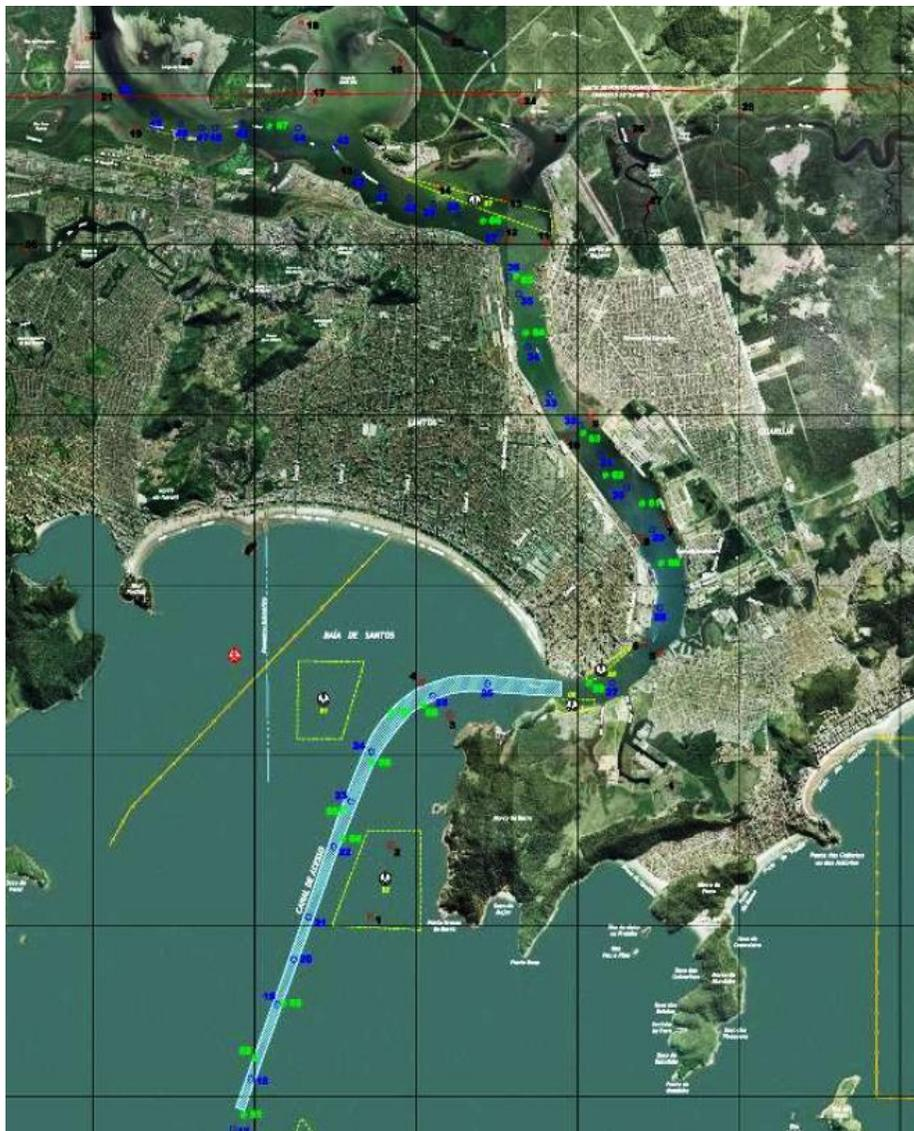
Fig. 3.44 Seleção de toda a área de dragagem para permitir a entrada de embarcações, além de apontar a quantidade de sedimentos que são alocados em função da movimentação das marés. (Codesp, 2018. Pag.24 disponível em < <http://www.portodesantos.com.br/dcq-dragagem.php> > Acesso em 12 de janeiro de 2012.)
