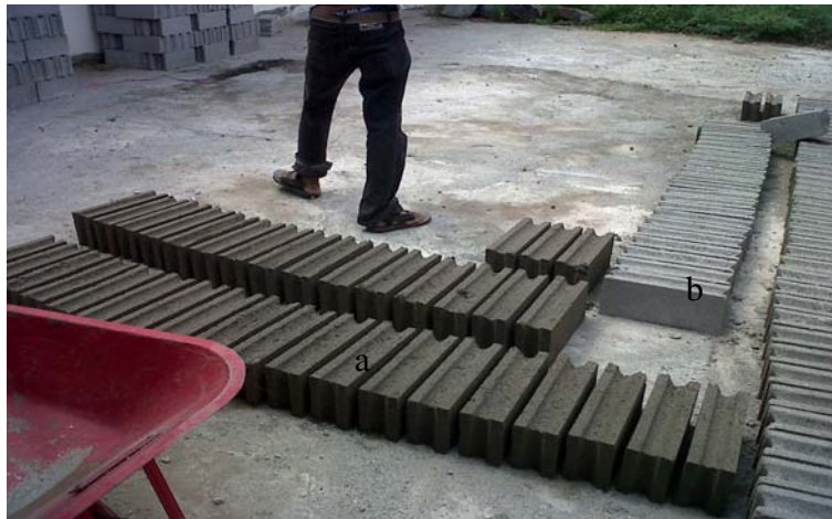
Gambar 3. a. Batako baru dicetak dan b. Batako yang sudah berumur 7 hari
