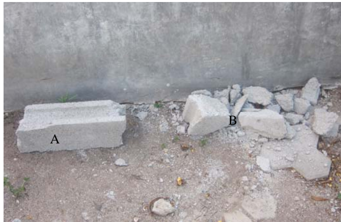
Gambar 4. Uji Jatuh Batako, (A) Batako Menggunakan Abu Terbang Batubara; (B) Batako Tanpa Abu Terbang Batubara
