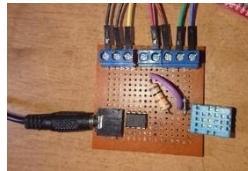
Fig. 7. Conexión de componentes en PCB perforada
