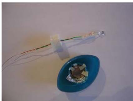
Fig. 2. Circuito del led, cables y la pila.
