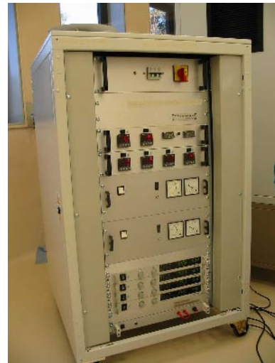
Figura 8: Simulador solar; fuentes de alimentación y sistemas de control.
