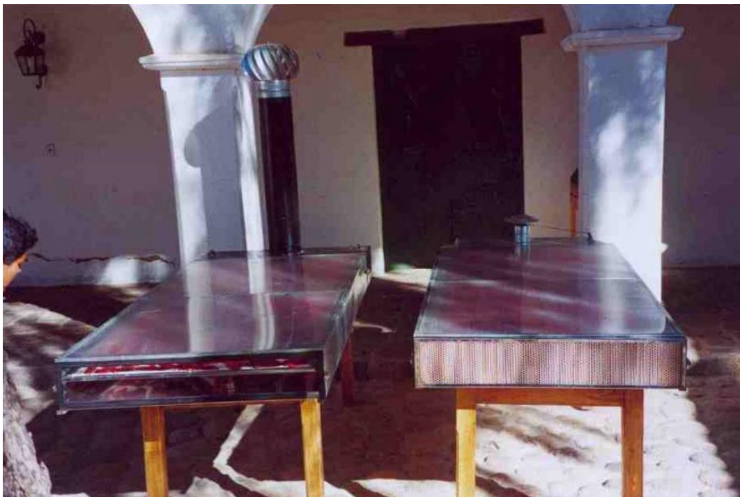
Figura 1: A la izquierda el secador SN10 sin su puerta de entrada con filtro de aire. Se observa la chimenea y el extractor eólico. A la derecha el secador SF10 con motor eléctrico. Ambos secadores están cargados con carne.
