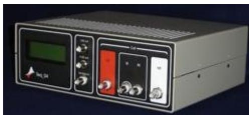
Fig. 2.8. Potenciostato-galvanostato Teq-03 utilizado para las experiencias electroquímicas en el presente trabajo.
