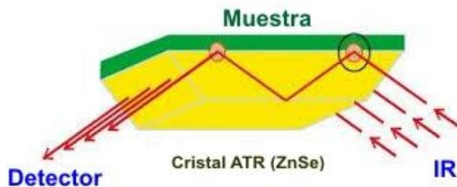
Fig. 2.10. Diagrama explicativo del paso del haz de luz infrarroja en el modo ATR-FTIR.
