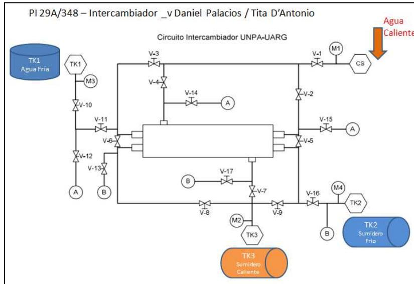
Figura 6: – Conexión definitiva de los elementos del sistema..
