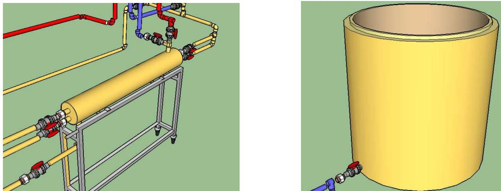
Figura 4: – (izq) Intercambiador y (der) Tanque de alimentación
