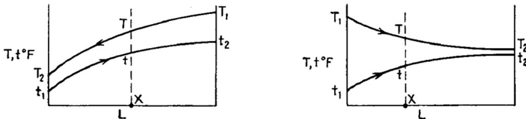
Figura 2: – (izq) Evolución de temperaturas en configuración de flujo en contracorriente y (der) en la configuración de flujo en paralelo
