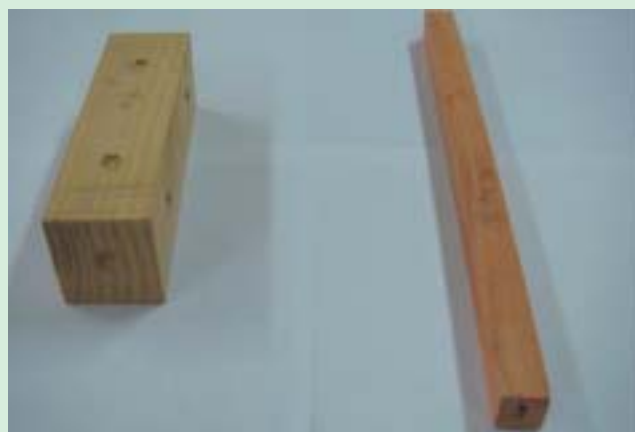
Probetas, dureza y flexión
