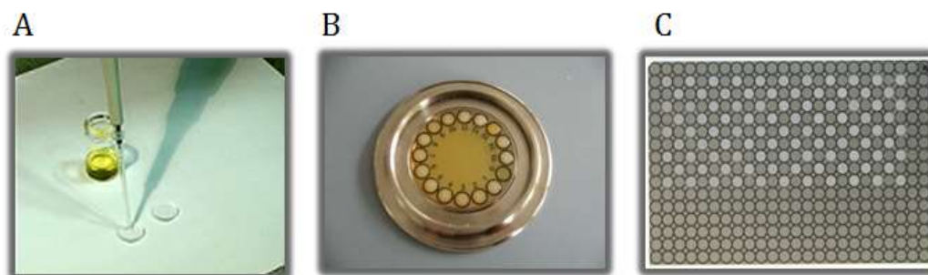
Figura 16. Técnica del film seco. A. Films preparados sobre celdas de \text{CaF}_2 . B. Films preparados en una celda de ZnSe con 15 pocillos. C. Films preparados sobre una celda multipocillo de Si con 96 pocillos para determinaciones automáticas.
