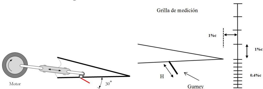
Figura 2. Diseño de sistema de accionamiento del flap
