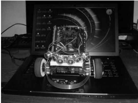
Figura 1. Robot N6 con las unidades sensoras
