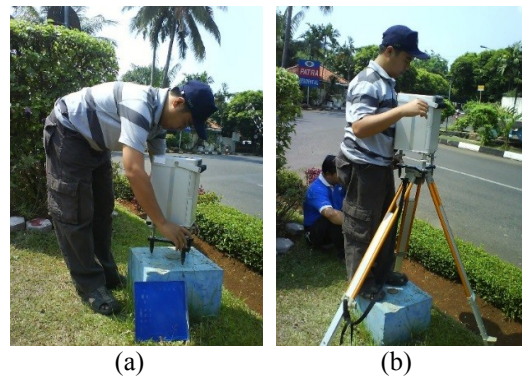
Gambar 3 Pengukuran gayaberat dengan metode gradient vertical (a) Pengukuran di permukaan; (b) Pengukuran gayaberat ketinggian tertentu dari permukaan (80 cm)
