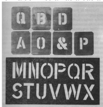
Figura 2. Plantillas de letras para embalajes, que "resuelven" el problema de las islas, conectadas por medio de puentes.
