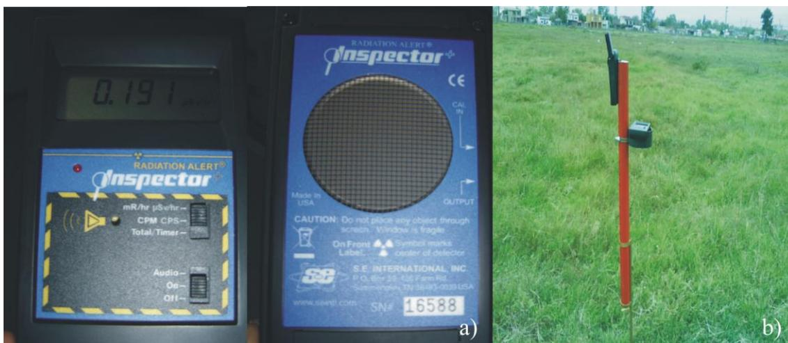
Figura 3.2: a) Detector Geiger Müller y b) arreglo experimental para la medición de dosis, detector colocado a 1 m de la superficie terrestre.
