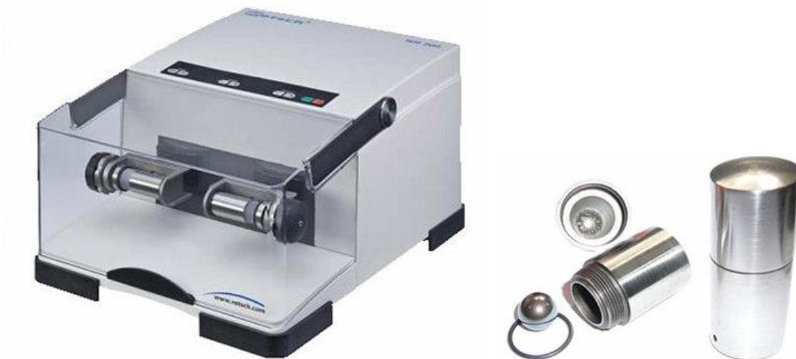
Figura 4.1: Fotografía del molino vibratorio horizontal, similar al empleado para la preparación de las muestras de esta tesis (izq.). Cilindros y bola usados en el proceso de molienda (der.).
