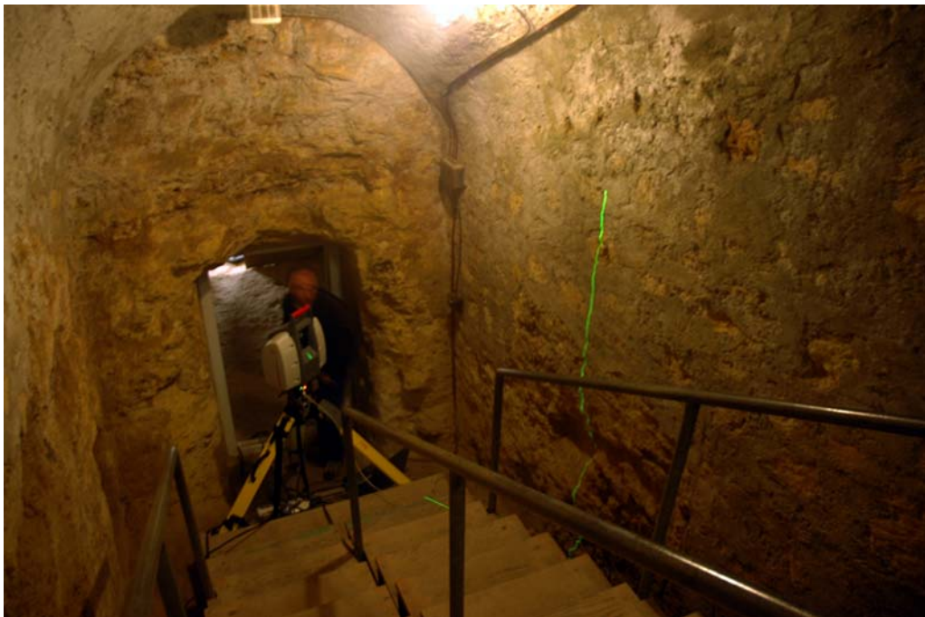
Fig. 2. La "lama di luce" dello scanner TOF durante la scansione della Tomba della Caccia e della Pesca a Tarquinia (VT).
