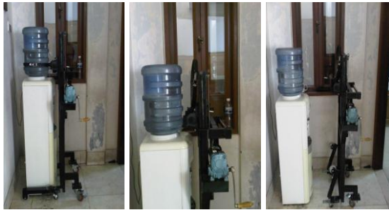
Gambar 20 Posisi Pemasangan (Kiri), Posisi Gallon Di Lepas (Tengah), Posisi Selesai Pemasangan (Kanan)
