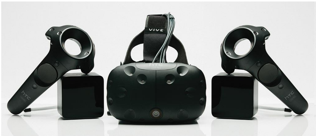
Figura 19: Sistema HTC vive, con Headset, Controllers e Lighthouses
