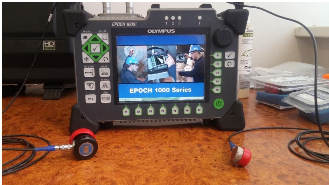
Obr. 38: Přístroj Olympus Echo 1000i a dvě sondy pro měření podélných ultrazukových vln (vlevo 4 MHz, vpravo 1 MHz)
