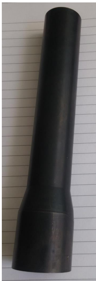
Obr. 14: Polotovar pro sonotrodu A
