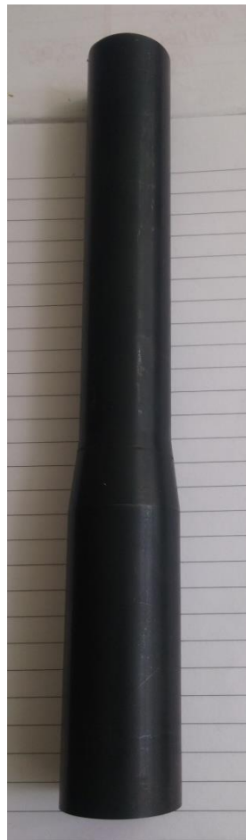
Obr. 15: Polotovar pro sonotrodu B
