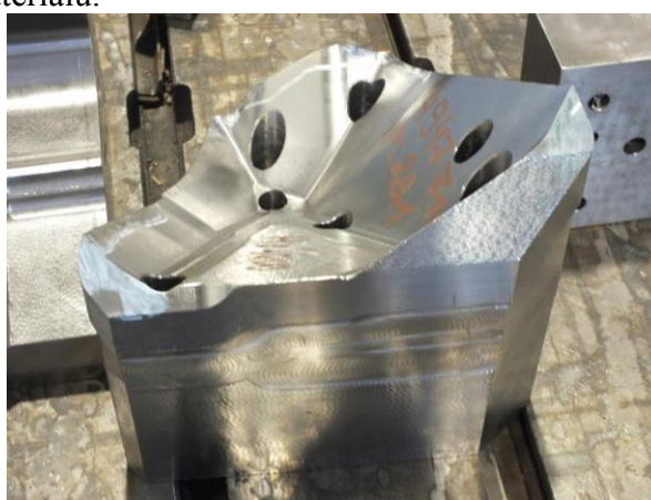
Obrázek 1: Vlevo robotický manipulátor s laserovou hlavicí. Vpravo ukázka formy určené pro laserové kalení hran.
