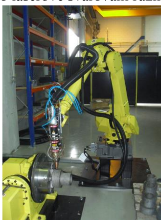
Obrázek 1: Vlevo robotický manipulátor s laserovou hlavicí. Vpravo ukázka formy určené pro laserové kalení hran.
