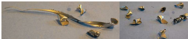
Obr. 4 Tvar třísek (zleva E, A)
