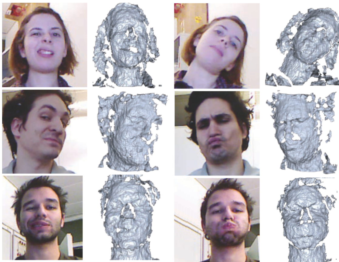
Obrázek 1.3: Ukázka pořízených dat z hrací konzole Kinect. Při rychlém pohybu hlavy část 3D dat chybí (díry) a navíc data obsahují hodně šumu. Obrázek převzat z [121]
