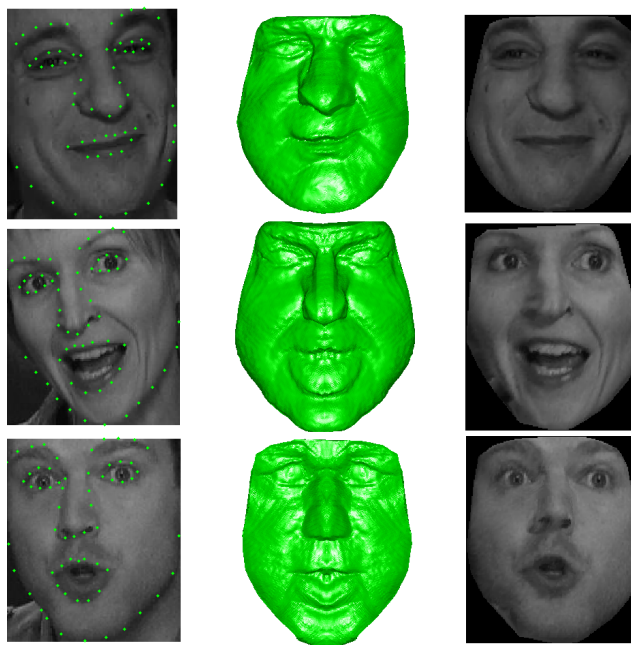
Obrázek 4.5: Ukázka vstupu a výstupu systému pro 3D rekonstrukci tváře. První sloupec je vstup do systému, druhý sloupec je rekonstruovaný 3D objekt a třetí sloupec je tvář normalizovaná na čelní pohled.
