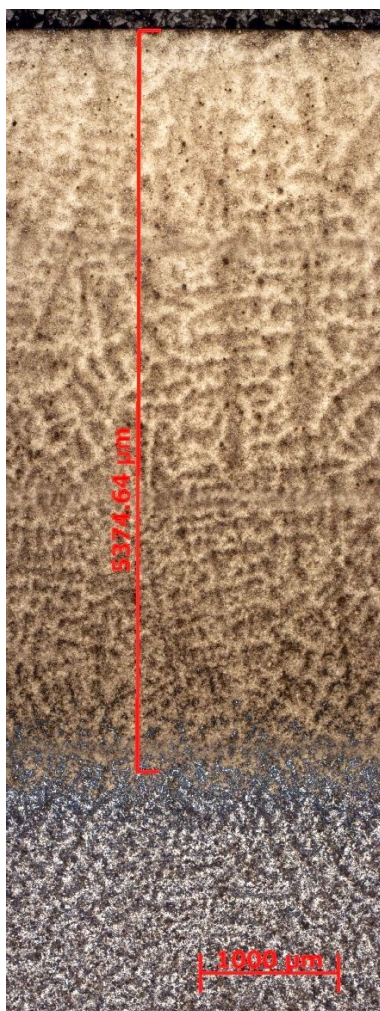
Obr. 14-7, Materiál ČSN 41 6343.0, hloubka zakalené vrstvy, leptáno Nital 3%, zvětšeno 25x
