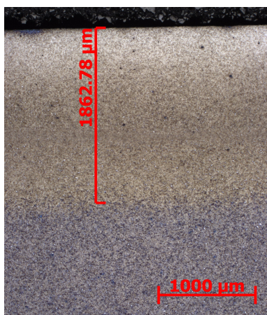
Obr. 14-13, Materiál ČSN 41 9573.3, hĺoubka zakalené vrstvy, leptáno Nital 3%, zvětšeno 25x
