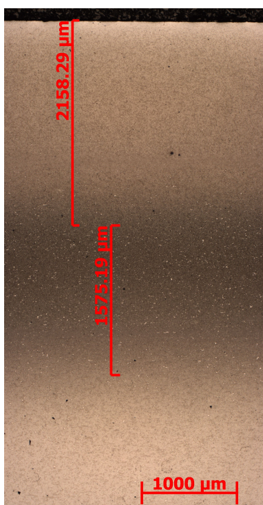
Obr. 14-15, Materiál ČSN 41 9573 T1, hloubka zakalené vrstvy, leptáno Nital 3%, zvětšeno 25x
