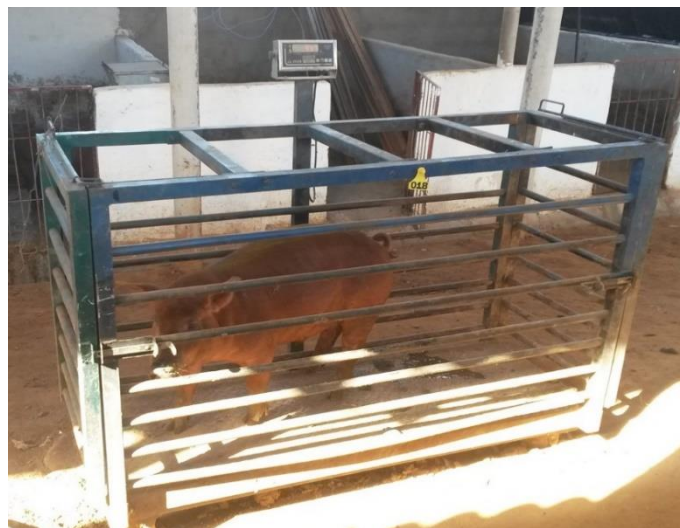
Figura 17. Balança eletrônica modelo LD1050 acoplada a estrutura de contenção para pesagem dos animais.
