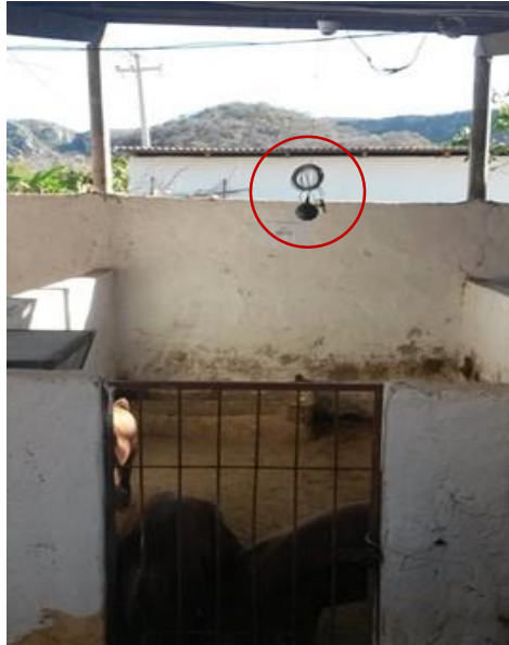
Figura 12. Datalogger HOBO U12-12 instalado no interior da baía.
