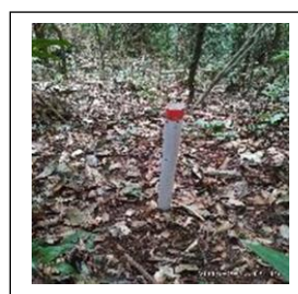
Cara pemasangan tongkat ukur erosi tanah
