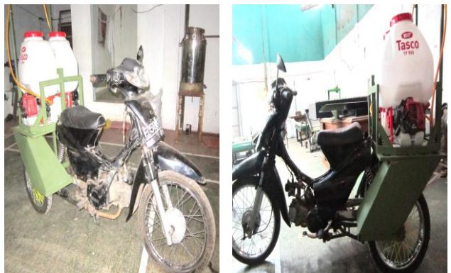
Gambar 11 Mobile sprayer machine (prototipe B) hasil modifikasi.
