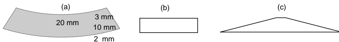
Gambar 6 (a) Asal bilah bambu, (b) penampang aktual, dan (c) penampang tertransformasi.
