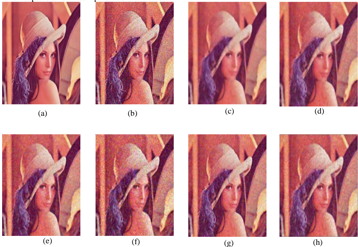
Gambar 5. Uji coba perbandingan metode penghilangan noise . (a) Citra asli. (b) Citra ber- noise . Metode total variation (c-d), filter median (e-f) dan filter rata-rata (g-h). Kolom kiri, penerapan metode penghilangan noise pada model warna CB dan kolom kanan pada model warna HSV.
