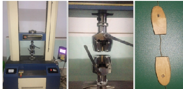
Gambar 2. Foto Uji Tarik Serat dengan Computer Material Testing Machine
