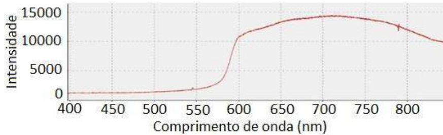
Figura 24 - Espectro de uma lâmpada halógena
