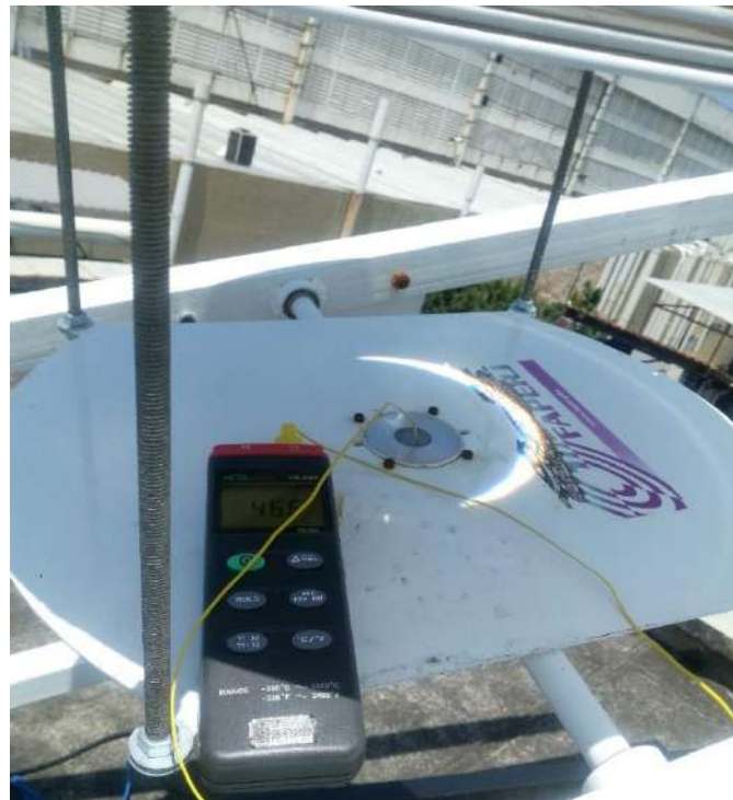
Figura 19 - Medida de temperatura do feixe com termopar
