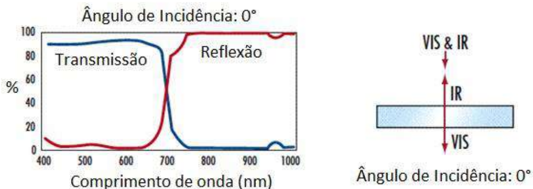
Figura 22 - Gráfico de transmissão do espelho dicróico (Adaptado de Edmund Optics [19])
