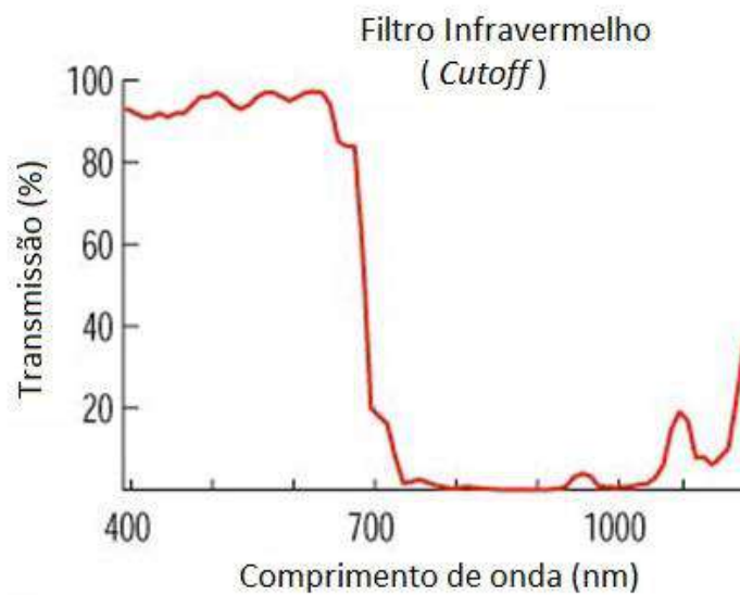
Figura 21 - Gráfico da transmissão do filtro "IR Cut-off" (Adaptado de Edmund Optics [18])
