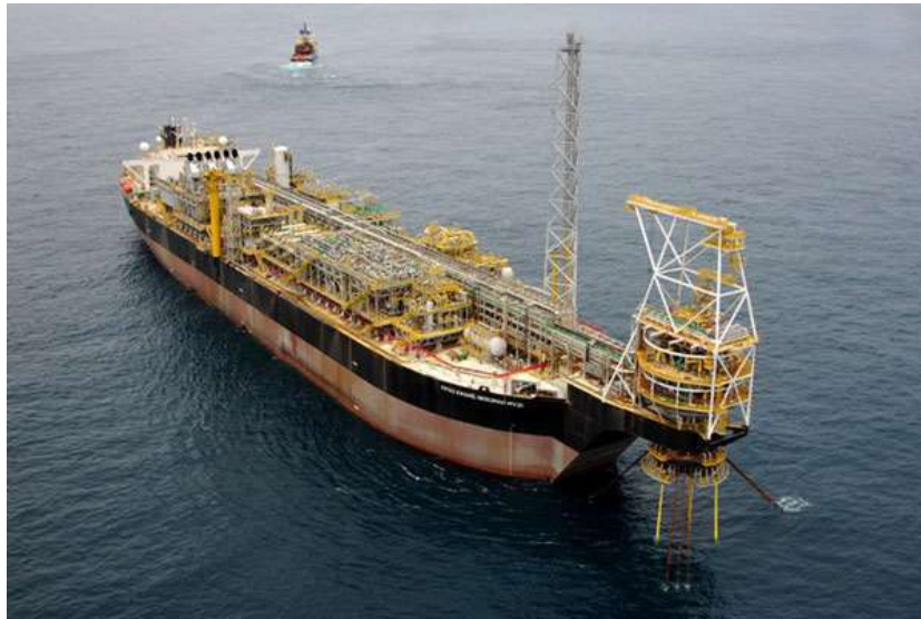
Figura 1-1 – Sistema Turret externo de ancoragem (Fonte: www.offshore-mag.com )
