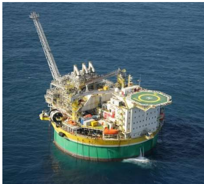
Figura 2-6 – Casco do FPSO Monocoluna (Fonte: www.petrobras.com.br )
