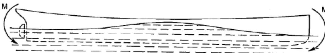
Figura 4-3 - Condição de alquebramento [21].
