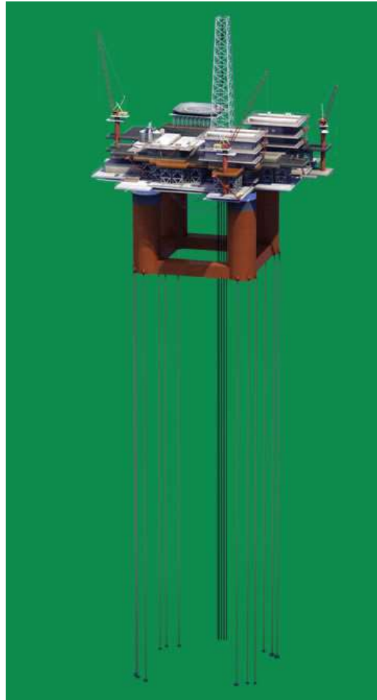
Figura 1-6 – Estrutura de uma TLP típica ( http://www.petrobras.com.br )
