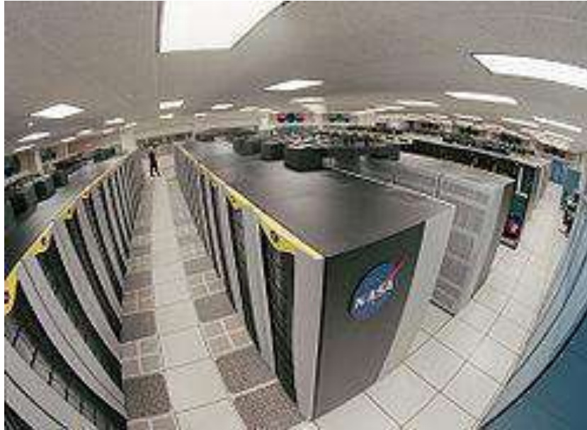
Figura 9 – Columbia, o novo (2004) cluster da NASA, 20 Altix clusters executando Linux (10,240 processadores)
