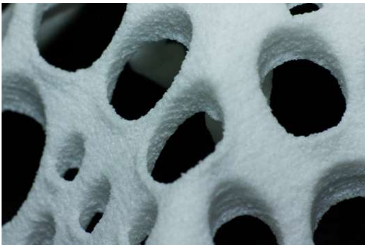
Figura 30: Ampliação da superfície do objeto teste prototipado, demonstrando as camadas que o compõe.
