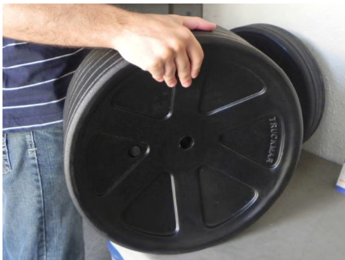
Fotografia 17: Pega da roda Truckmar L200, aproveitando a sua forma cônica Fonte: O autor (2011)
