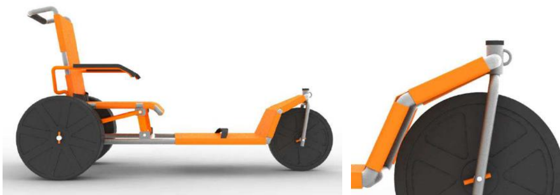
Figura 9: Perfil da cadeira. Sua extensão alongada permite uso de pessoas grandes, existem cintos de segurança no encosto e no apoio de pés e um pequeno gancho é soldado na frente para poder ser puxada por uma corda (no detalhe). Fonte: O autor (2011)
