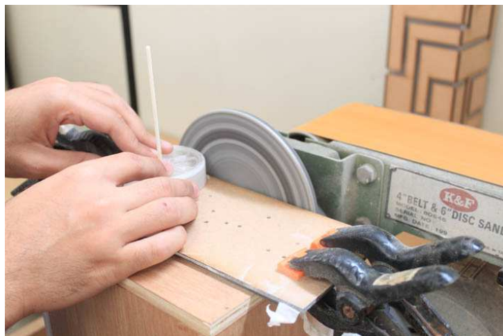
Fotografia 21: Roda frontal sendo girada na lixadeira Fonte: O autor (2011)
